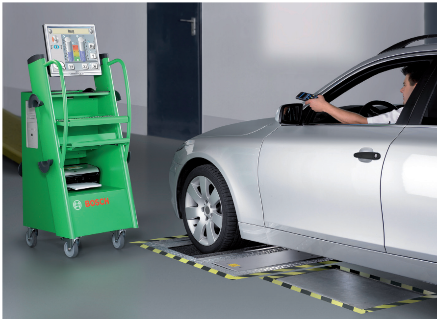
Bild 14. Bromsarnas effekt och skick kontrolleras med en bromsdynamometer på verkstaden och vid bilbesiktningen.
