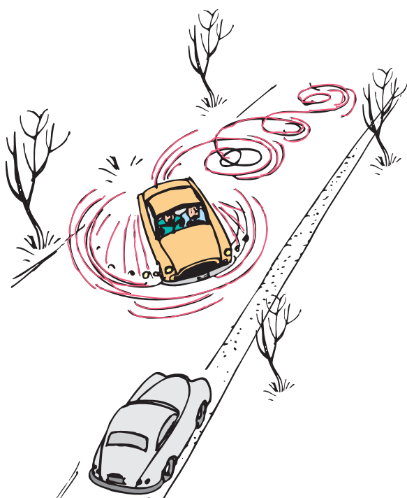
Bild 16. Om bakhjulen låser sig före framhjulen tappar bilen sin körriktning.
