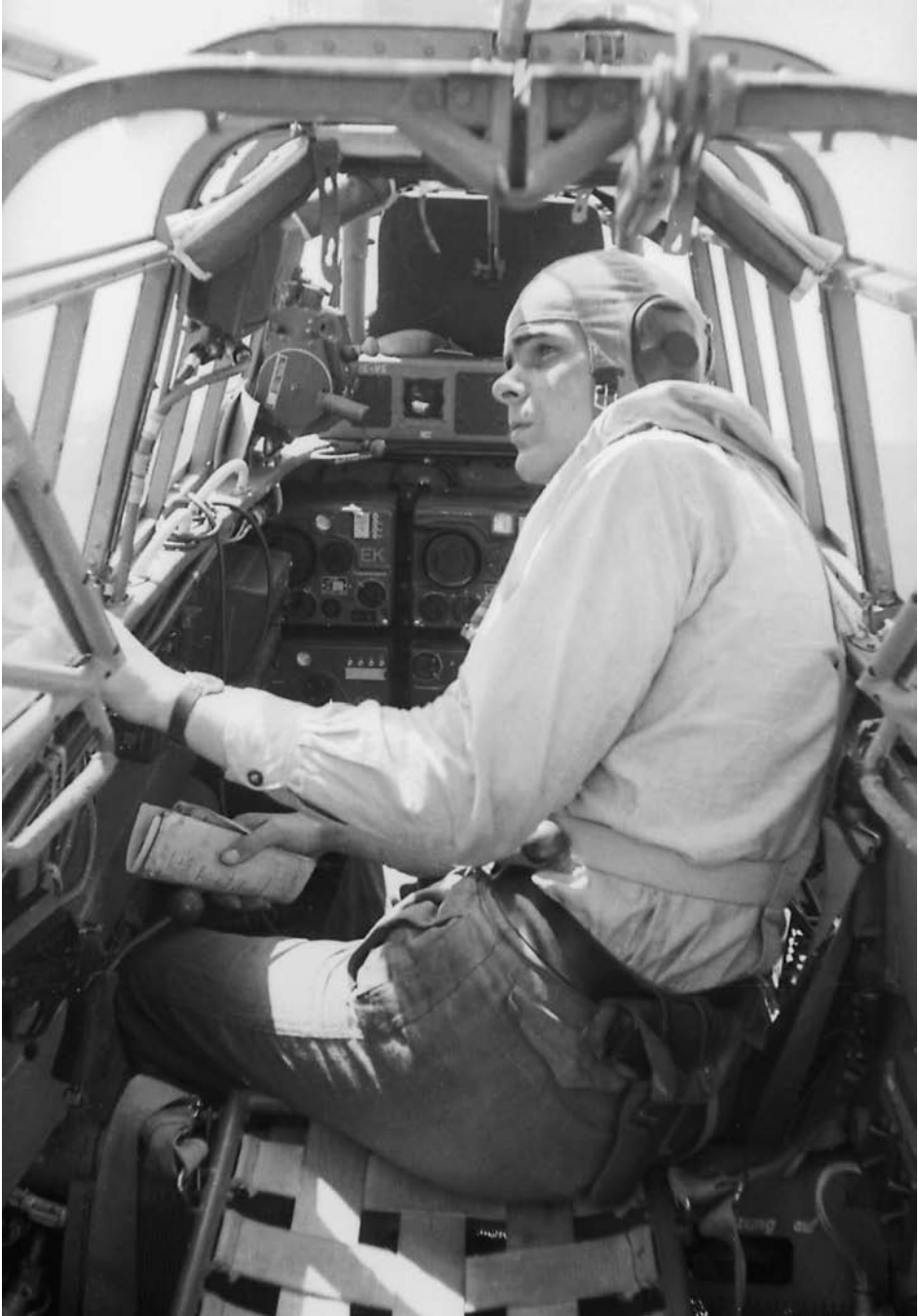
Radistin paikka Bf 110:ssä. Lennolla Irakiin tähän tilaan piti suloa lisäksi mekaanikko, öljytankki käsipumpulla varustettuna ja paljon muita varusteita.
