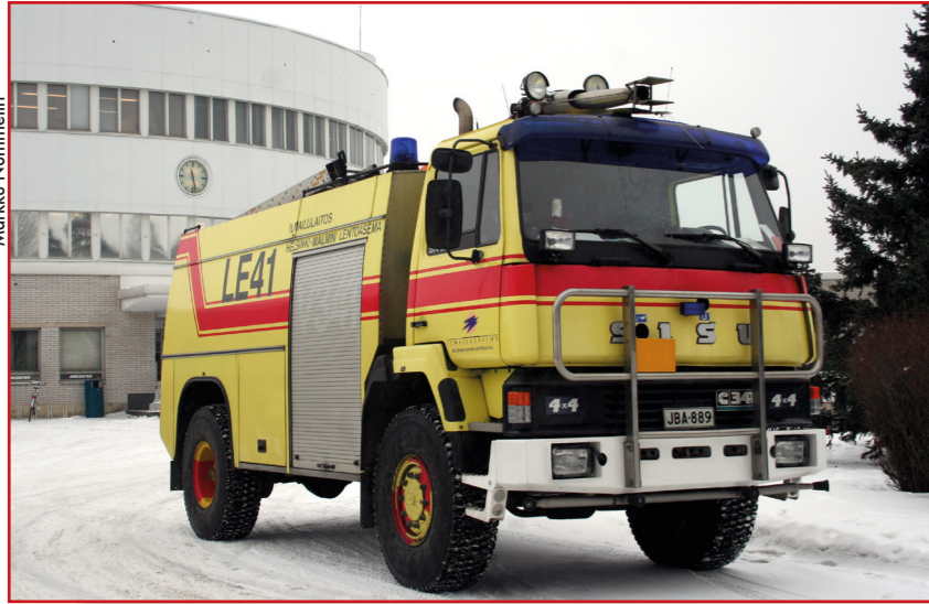
Malmin lentoseman SISU SK 250 4x4 -sammutusauto vuodelta 1991. Autossa on 2500 litran vesi- ja 210 litran vahtonestesäiliöt.
