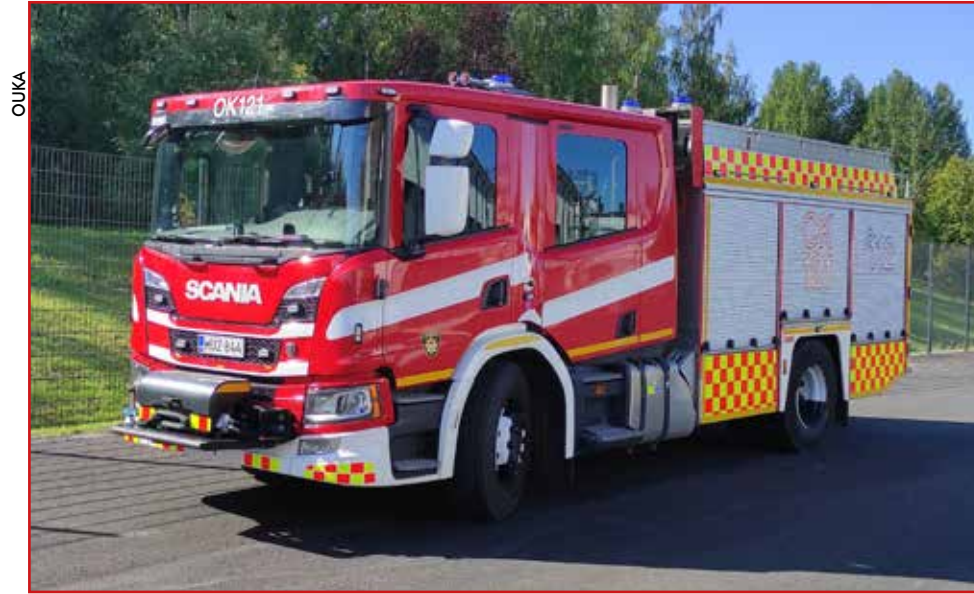
Säiliösammutusautossa on yhdistetty sammutusauton ja säiliöauton ominaisuudet. Vesisäiliön tilavuus on vähintään 5000 litraa.
