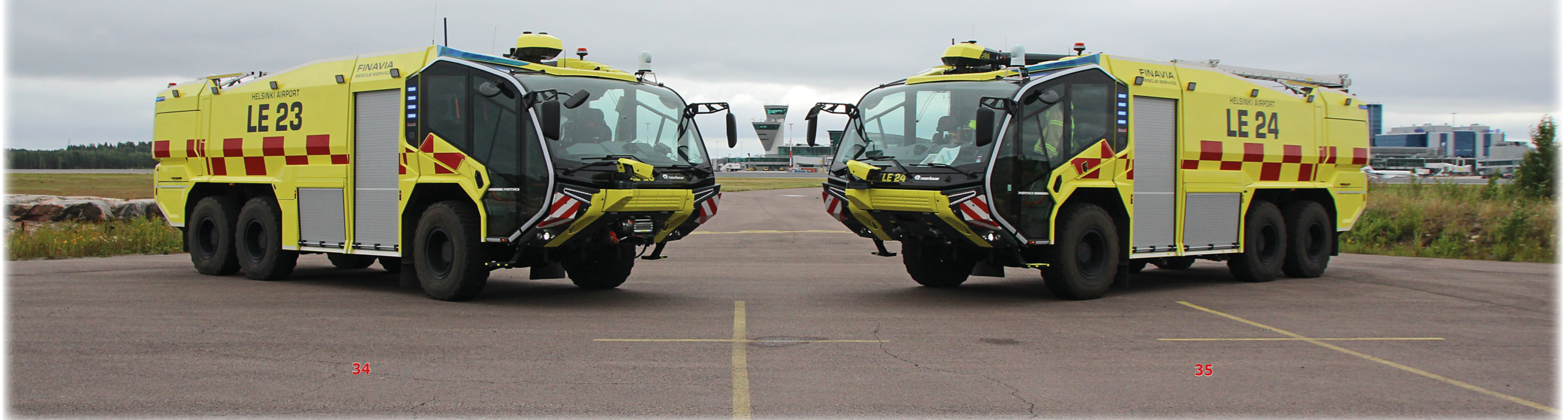
Helsinki-Vantaan lentoaseman Rosenbauer Panther 6x6 -autot LE23 ja LE24 ovat vuosimallia 2018. Autoissa on 12 500 litran vesi- ja 1300 litran vahtonestesäiliöt.
