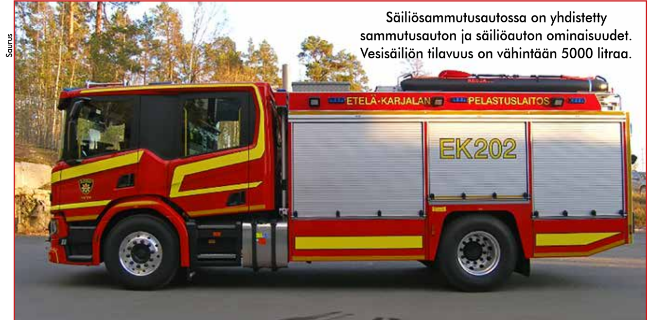
Etelä-Karjalan pelastuslaitoksen Imatran paloaseman säiliösammutusauto EK202. Autossa on Esteri D-240 -peräpumppu ja 6,8 tonnin hydraulivinssi.
